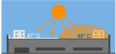
In un giorno sereno, la superficie di copertura è esposta alla radiazione solare diretta. Sopra la copertura si instaura una zona particolarmente calda, caratterizzata da livelli di temperatura dell'aria significativamente più elevati dell'ambiente circostante
